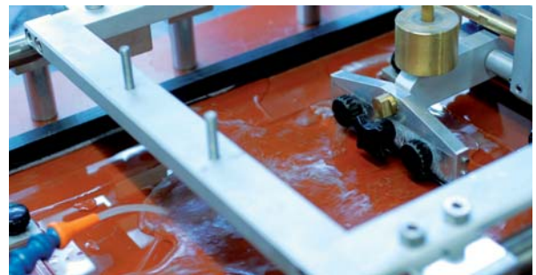
Abriebfestigkeit Bei der Bohle-Testmethode wird ein handelsüblicher Gummiabzieher, der mit 450 g belastet wird, maschinell über eine beschichtete Glasscheibe geschoben und gezogen. Ein Wischzyklus besteht aus einer Schieb- und einer Ziehbewegung.
